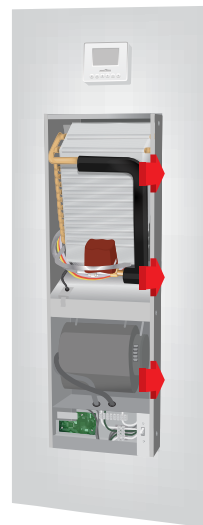
Step 6 Insert Unilux Retrofit VFC
